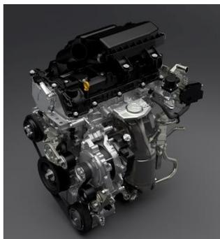
Il nuovo motore K12D 1.2 DUALJET che alimenta la Swift rivisitata è dotato di un sistema a doppia iniezione e offre sia una risposta potente sia un'elevata efficienza in termini di consumi di carburante. Questo equilibrio è reso possibile grazie a miglioramenti quali un'aspirazione elettrica VVT (fasatura variabile delle valvole), una pompa dell'olio a capacità variabile e getti controllati elettronicamente per il raffreddamento dei pistoni.
