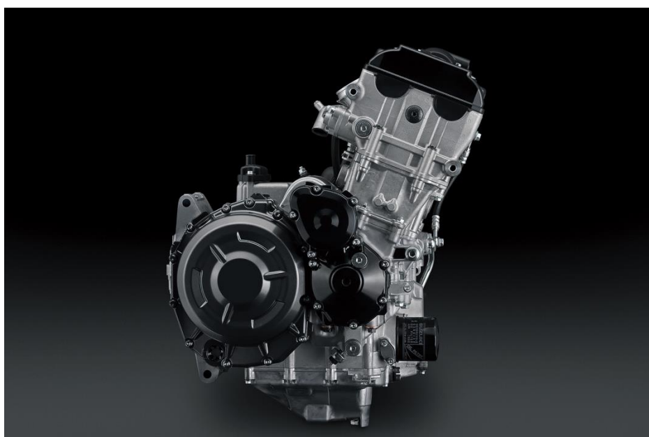
Moteur quatre temps, quatre cylindres à refroidissement liquide, DACT, 1340 cm 3
