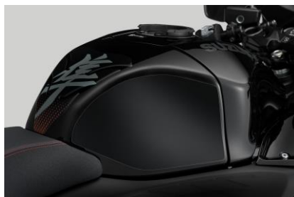
19 Sticker de protection du réservoir de carburant
