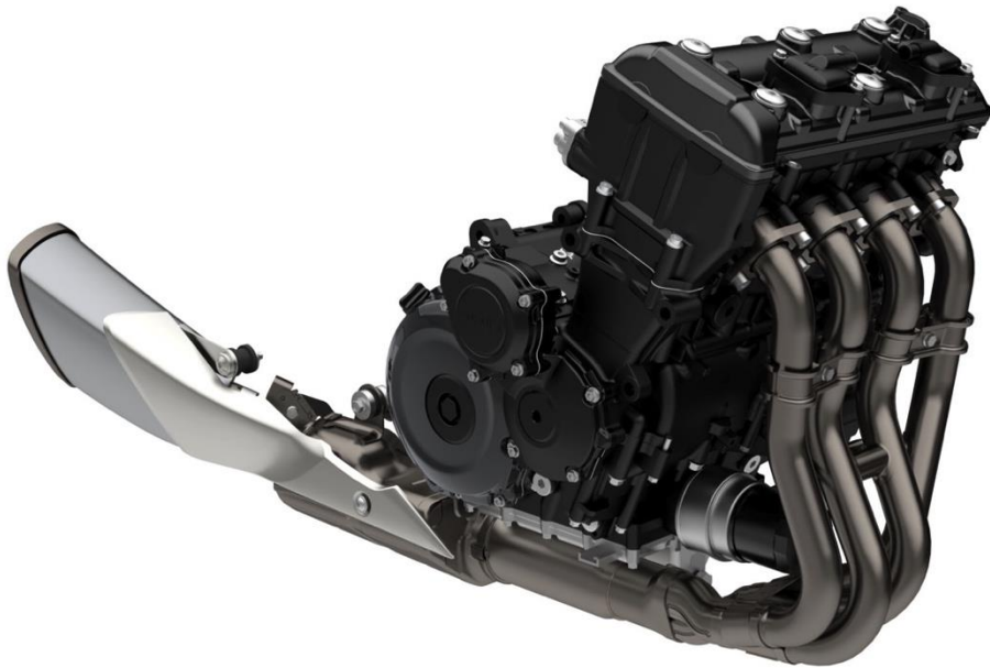
Motore a 4 tempi, 4 cilindri, raffreddato ad acqua, DOHC, 999cm 3
