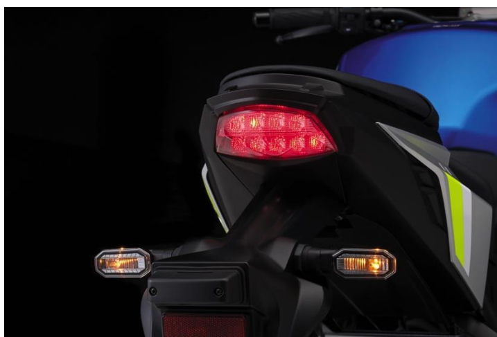
Faro posteriore combinato a LED e indicatore posteriore a LED
